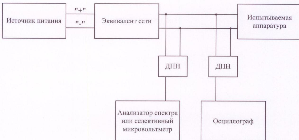
Рисунок 10.1 – Конфигурация приборов для измерения помех в цепях питания
